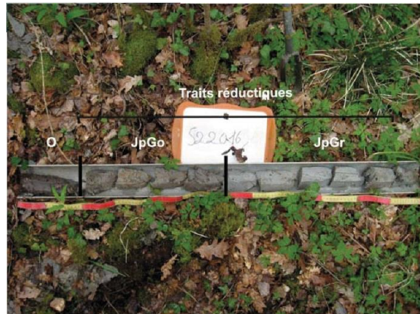
Photo 3 bis : Sondage présentant un horizon réductique (© Lionel Berthier, Marine Lacoste - Agrocampus Ouest)
